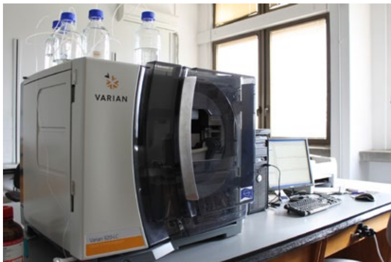
Hplc 42 – течен хроматограф
